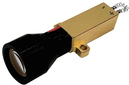
T01系列人眼安全激光发射天线，是由杏林睿光自主研发的半导体泵浦被动调Q铟玻璃激光器与发射天线、光电探测器（PD）组成的一体化激光模组，专业应用于激光测距、激光遥感、激光雷达等领域。该模组输出1535nm人眼安全波长激光，并提供激光同步信号，具有体积小、发散角小、宽温工作等特点。
