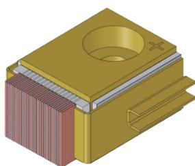
GS07封装形式的半导体激光器阵列是杏林春光开发的一款高温（70℃）下使用的小型化、多波长产品，亦可单一波长输出，巴条长度5mm，单巴条功率150-200W，可封装15个巴条，其它波长、封装形式可接受定制。
